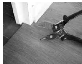
Cisaille à ongle Reference : Romus : 93401 / Janser : 237 530 000 Pour découpe autour des pieds d'huisserie, endroits difficiles d'accès.
